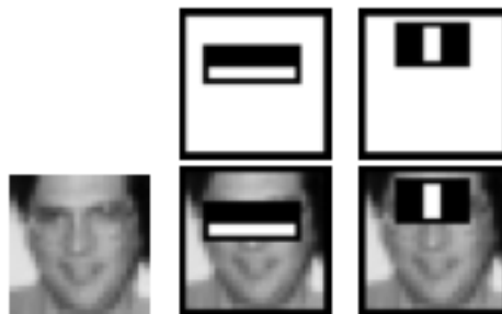
Abbildung 6: In der oberen Reihe sind die ersten beiden Basisklassifikatoren dargestellt, die von AdaBoost in [VJ01] gewählt wurden. Zur Veranschaulichung wurden sie über ein typisches Bild aus dem Trainingsdatensatz gelegt. Der erste Klassifikator misst den Unterschied der Intensitäten zwischen der Augen- und Wangenpartie. Im zweiten Fall wird der Kontrast zwischen Nasenrücken und Augenhöhlen gemessen.
