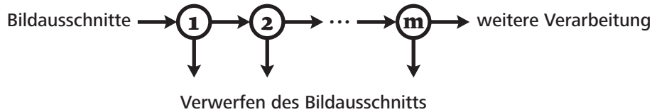
Abbildung 7: Degenerierter Entscheidungsbaum: Der Kaskade von Klassifikatoren werden die zu untersuchenden Bildausschnitte übergeben. Diese werden in der Kaskade nur dann weiter gereicht, wenn sie als Gesichtsregionen klassifiziert wurden, anderenfalls werden sie verworfen. Nur wenn ein Bildausschnitt von allen m Klassifikatoren der Kaskade positiv klassifiziert wurde, enthält er mit Wahrscheinlichkeit p(x|z) = 0,98 ein Gesicht (Gleichung 2.5).
